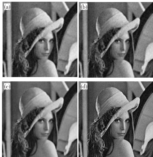
图 4 低分辨率序列重建结果。(a) 双线性插值图像;(b) 基于梯度的插值图像;(c) 传统的 POCS 算法重建高分辨率图像;(d) 本文算法重建高分辨率图像。
